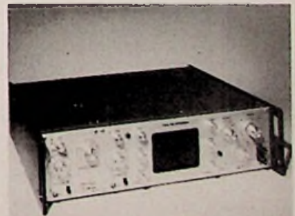
10 MHz oscilloscoop in bouwdoosvorm, type BEM-016 van Polykit, hier met tweede Y-kanal uitgebreid (BBT-016).
